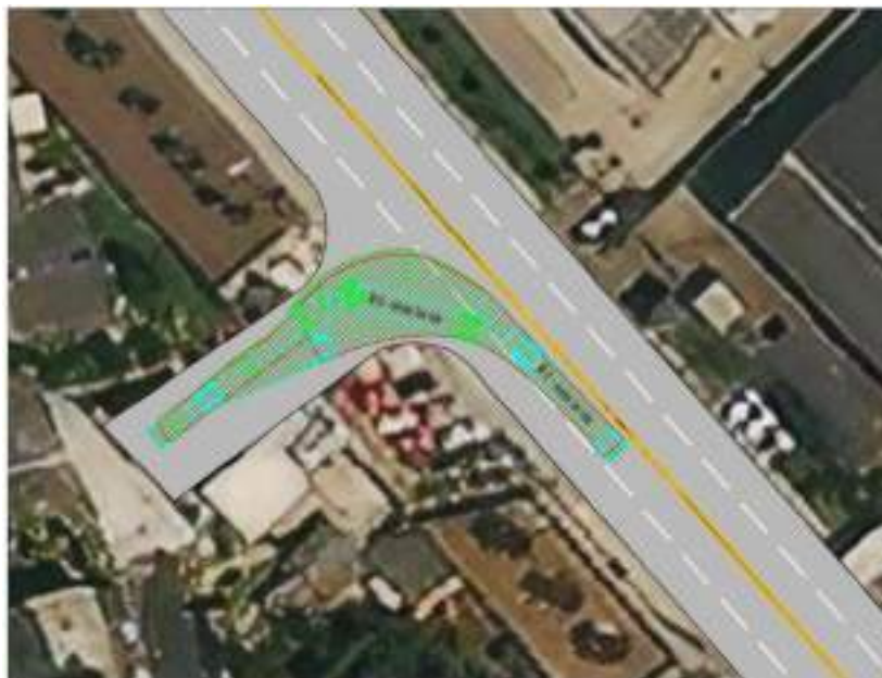
Figura 13. Trayectoria en maniobra de giro de un camión
