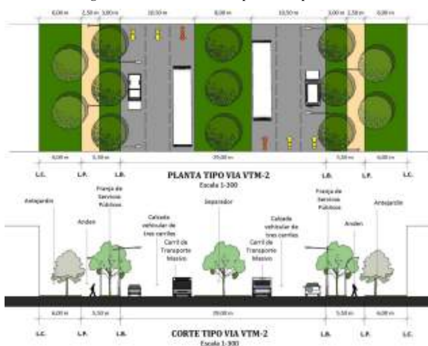
Figura 9. Sección transversal para vías tipo VTM-2
